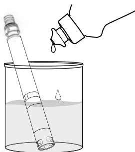
圖 72 使用洗潔精清潔 pH 和 pH/ORP 傳感器
