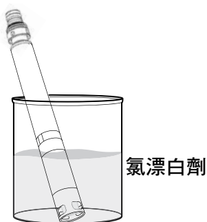
圖 74 使用氯漂白劑清潔 pH 和 pH/ORP 傳感器
